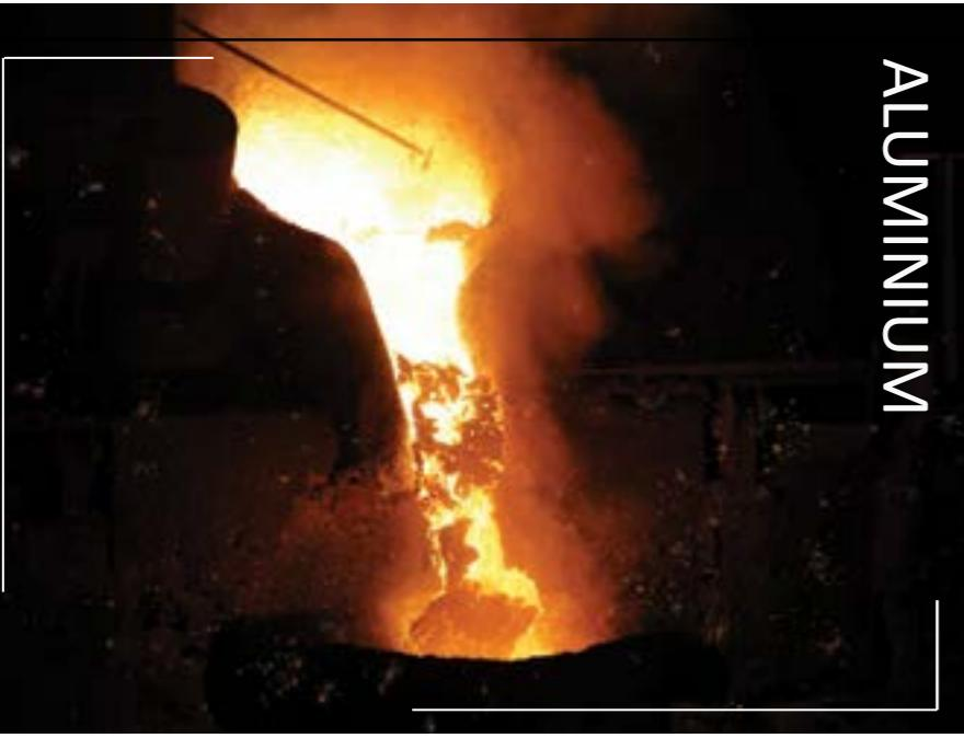
برای ذوب در سالن ریخته گری آلومینیوم از یک کوره ذوب ساز از نوع Melt tower از شرکت Insertec اسپانیا با ظرفیت ۵۰۰ کیلو گرم در ساعت و ۶ کوره بوته‌ای گازی، ۳ ماشین گاززدایی (محصول شرکت های FOSECO و PYROTEC) استفاده می‌گردد. این واحد هم چنین دارای تجهیزات اندازه گیری دانسیته جهت حصول اطمینان از سیستم گاززدایی و آخال زدایی می‌باشد.
